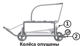
рис. 5 Механизм выдвигающих колёс
